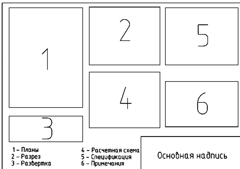
Рис. А.14. Схема второго графического листа для ленточного фундамента мелкого заложения
